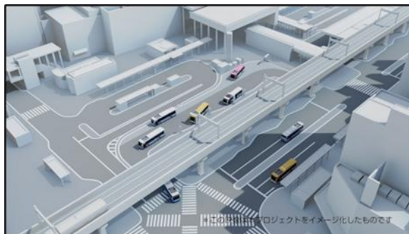
図 4：公共空間にパンタグラフ式充電器設置のイメージ図
